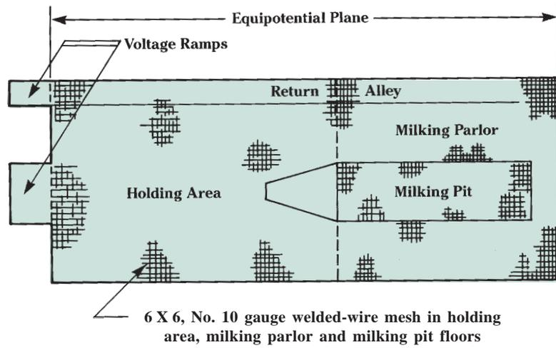
Figure 5. Equipotential Plane in a Free-Stall Barn
